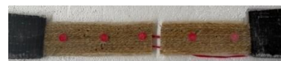
รูปที่ 15 การวิบัติของแผ่นคูปองผักตบชวาจากอีพอกซีธรรมชาติ
