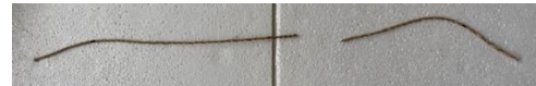
รูปที่ 5 ลักษณะการวิบัติของเส้นใยเดี่ยวจากผักตบชวา
