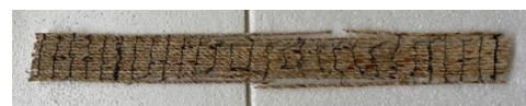
รูปที่ 6 ลักษณะการวิบัติของแผ่นเส้นใยจากผักตบชวา
